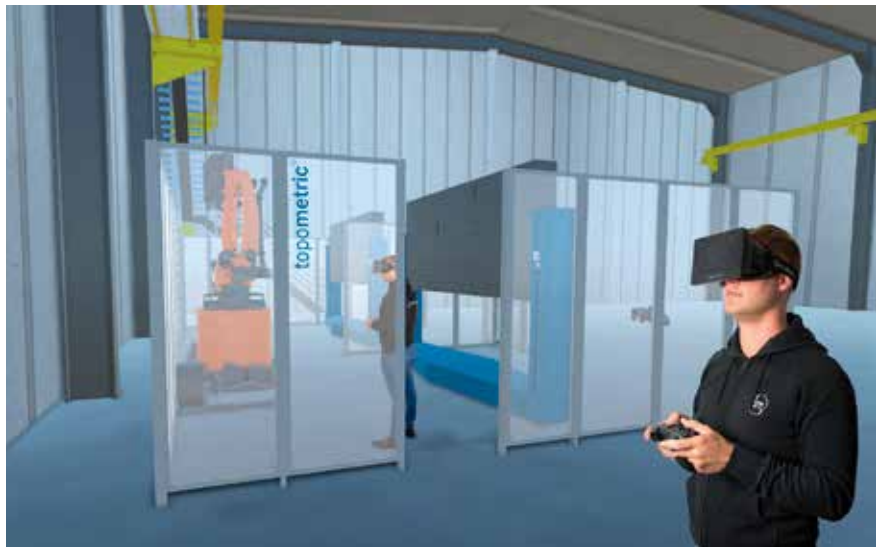
Bild 1. Virtuelle Begehung: Vor dem Aufbau einer 3D-Roboter-messzelle kann sich der Anwender ein genaues Bild von der zu installierenden Anlage in seinen eigenen Räumen machen. (© Topometric)
